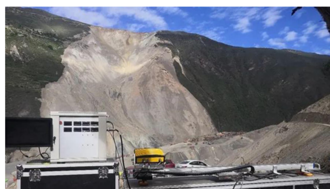
边坡雷达对金沙江白格滑坡进行监测
