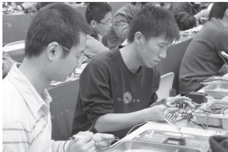
图3 用设计制作的热电传感器热电阻实验装置研究电烙铁温度分布情况
