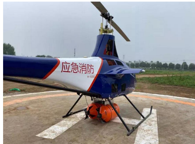
与团队研发的新型灭火系统中的无人机
