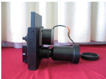
图 5 安徽光机所多波段偏振 CCD 相机 Fig. 5 The multi-band polarization CCD camera
