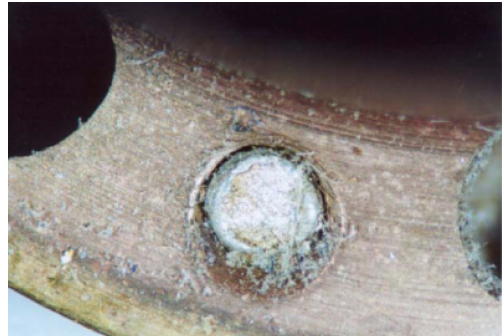
图 6 受真菌污染的俄罗斯空间站烟感探测器 [24]
