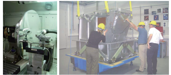
图3 SCUBA-2的自由曲面镜和光学支撑结构
