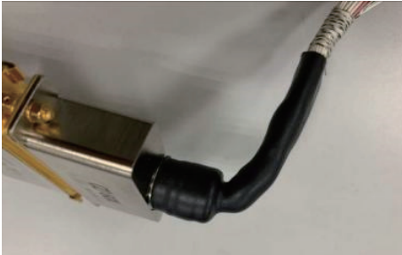
图 13 预成型ATUM热缩套管试验后状态
