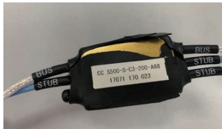
图11 S500型总线三端耦合器试验后状态
