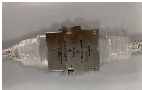
图6 J30JHJ型电连接器试验后状态
