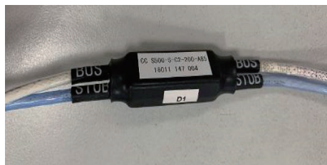
图10 S500型总线双端耦合器试验后状态
