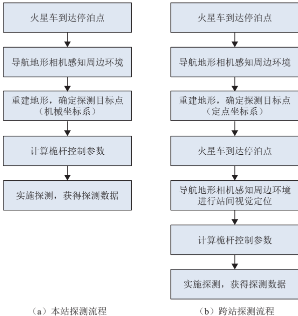
图 6 多光谱相机探测工作流程 Fig. 6 Work flow of Multi-spectral camera exploration
