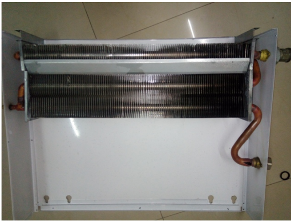
原爆裂的散热器
