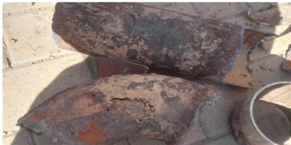
静园 D 南一次管道腐蚀漏水维修
