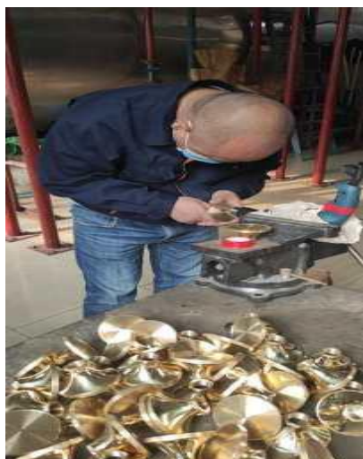
喷头二次加工（打孔）
