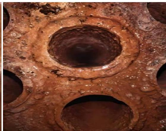
管板处腐蚀烟管漏水
